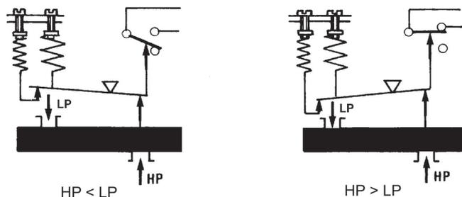
Un élément sensible déformable actionne un microrupteur par l'intermédiaire d'un levier. Le réglage de la consigne est obtenu par un ressort comprimable monté en opposition.
