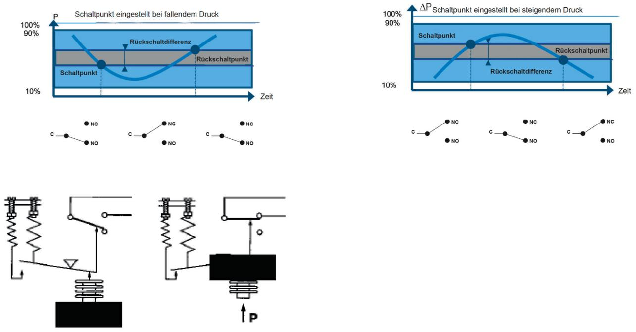
Ein flexibles Messelement betätigt mit Hilfe eines Hebels einen Mikroschalter. Schaltpunkt und Rückschaltdifferenz werden durch Spannen zweier Federn eingestellt, die der Kraft des Messelementes entgegenwirken.
